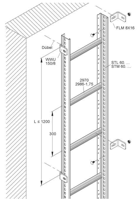
Eine Befestigung der Steigetrasse am Boden bzw. Decke ist ebenfalls möglich. Siehe hierzu Steigetrassebefestigungsadapter STBA 60... .
