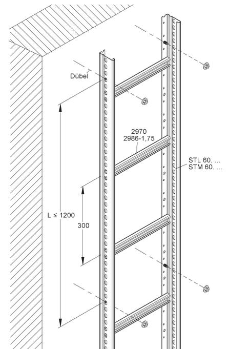
Eine Befestigung der Steigetrasse am Boden bzw. Decke ist ebenfalls möglich. Siehe hierzu Steigetrassebefestigungsadapter STBA 60... .
